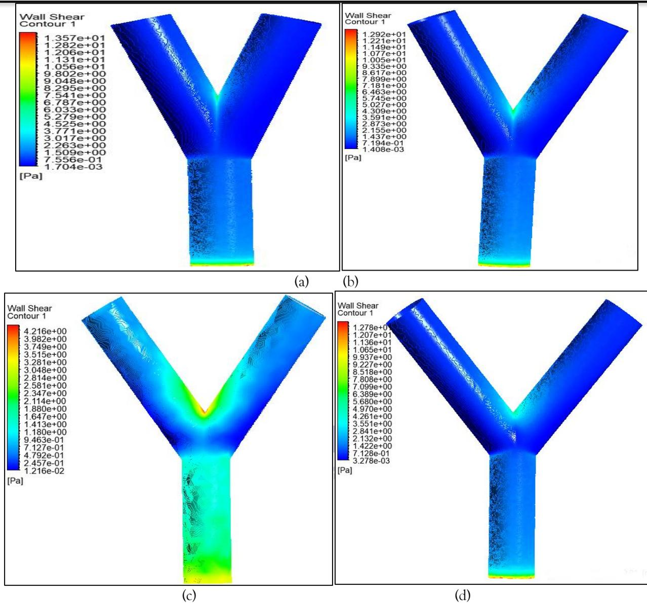
Figure 0.1 Simulations Model of (a) 35° (b) 50° (c) 65° (d) 75°
